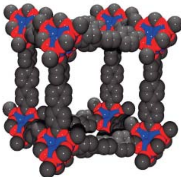
Abb. 4. Die Baugruppen L = (19) und Zn_4O(L)_3(MeOH)_4 (von L sind nur die Carboxylatgruppen gezeigt) und die darauf aufbauende 3D-Gerüststruktur von ^3\{[Zn_4O(L)_3(MeOH)_4]\} mit 91 % Porenvolumen (Lösungsmittelmoleküle in den Hohlräumen wurden weggelassen). Die Abstände zwischen den Mittelpunkten der Zn_4O -Baugruppen betragen 21,5 Å. Eine im Kristall vorhandene Fehlordnung der Baugruppen ist aus Gründen der Übersichtlichkeit nicht wiedergegeben. Zu den möglichen Methanalmolekülen an den Zn_4O -Baugruppen findet sich in der Veröffentlichung (merkwürdigerweise) kein Hinweis (Sauerstoff rot, Zink blau).
