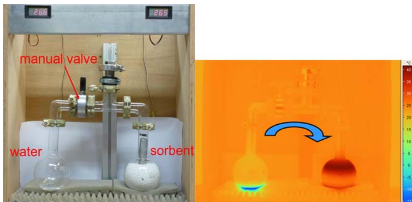
Abbildung 2: Links der Versuchsaufbau vor Öffnung des Ventils; rechts die Infrarot-Aufnahme mit Anzeige der unterschiedlichen Temperaturen von 5 °C im Wasserkolben und 45 °C im Sorptionsmaterial.
